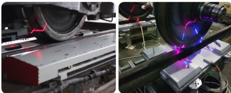
Рисунок 4 – Стационарные лазерные системы контроля колесных пар
